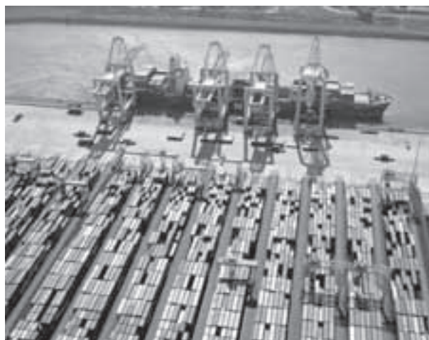
پایانه کانتینری ای.سی.تی. دلتا در بندر روتردام که از ترانستینر ریلی خودکار به عنوان تجهیزات صفافی محوطه استفاده می کند. جانمایی خطوط کانتینری به صورت آرایش قائم با امتداد اسکله است.
