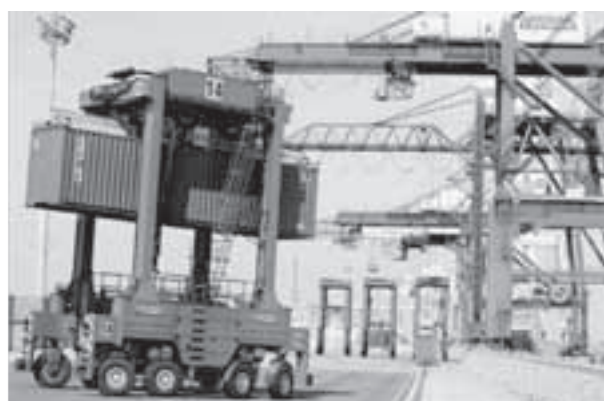
پایانه شرکت باتریک در فیشرمن آبلند بندر بریسیین - این پایانه تاکنون، تنها پایانه ای در جهان است که از سامانه استرادل کاریر خودکار (مشهور به Auto Strad ) استفاده کرده است. جانمایی خطوط کانتینری به صورت آرایش قائم بر امتداد اسکله است.
