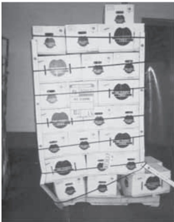
تصویر ۵- مهاربندی ناکافی کارتن‌های سیب
