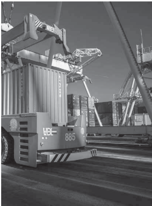
تصویر 8- کفی خودران در حال بارگیری کانتینر در محوطه کانتینری
