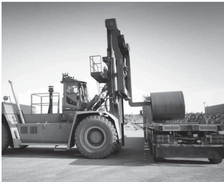
تصویر 2- لیفتراک سنگین در حال تخلیه رول ورقه فولادی از کشتی
