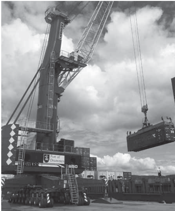
تصویر 4- جرثقیل متحرک ساحلی در حال تخلیه بار از کشتی
