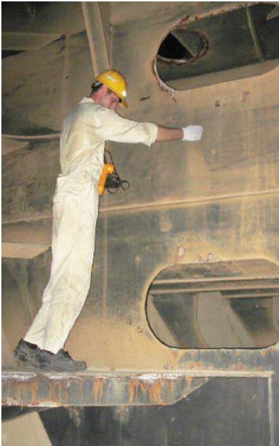
◀ ضخامت‌سنجی مخازن آب توازن کشتی فله بر ۴۳ هزار تنی - عکس از آرشیو شخصی سال ۱۳۸۰
