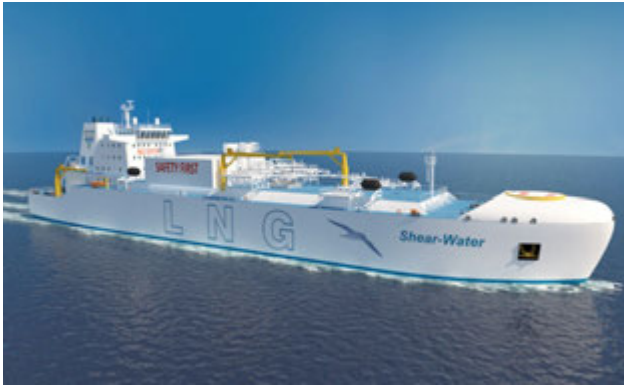
Figure 17. 18,700 m 3 LNG Feeder & Bunker vessel « Shear-Water»
